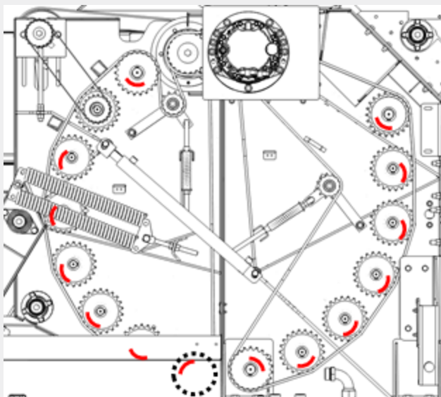
Figure 7.28 : 检查衬套是否有间隙。红色标记表示衬套上的区域。
