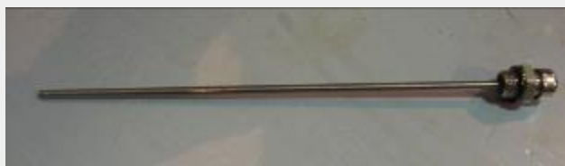
Figure 7.32: 带最高和最低油位指示器的油尺
