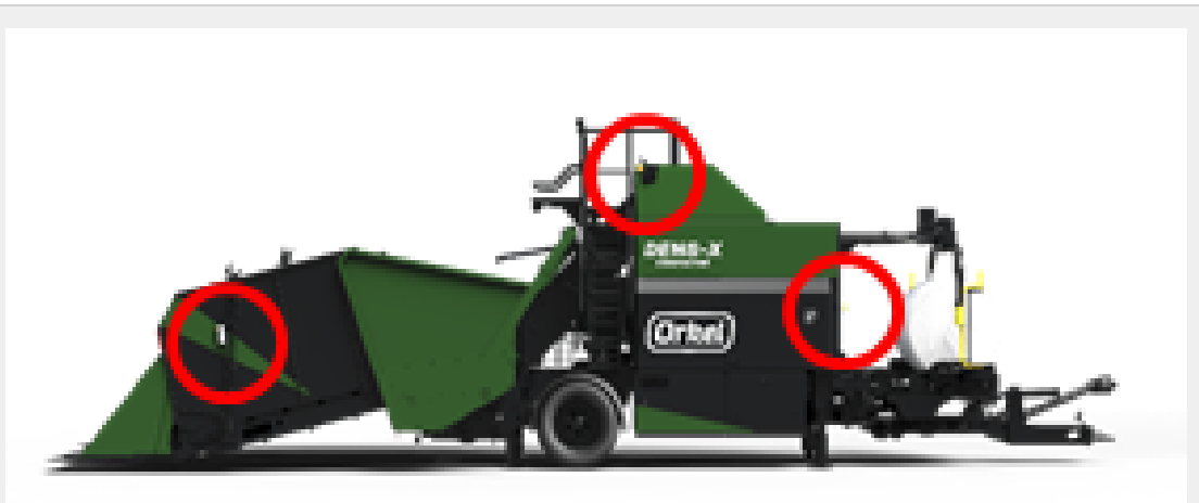
Figure 2.1: 红色圆圈表示急停位置。另外两个按钮位于另一侧，可从地面触及。
