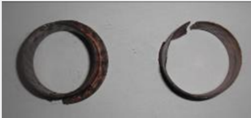
Figure 7.30： 滑动轴承的示例图片。左侧所示为新轴承，右侧所示为已经磨损/损坏的轴承。
